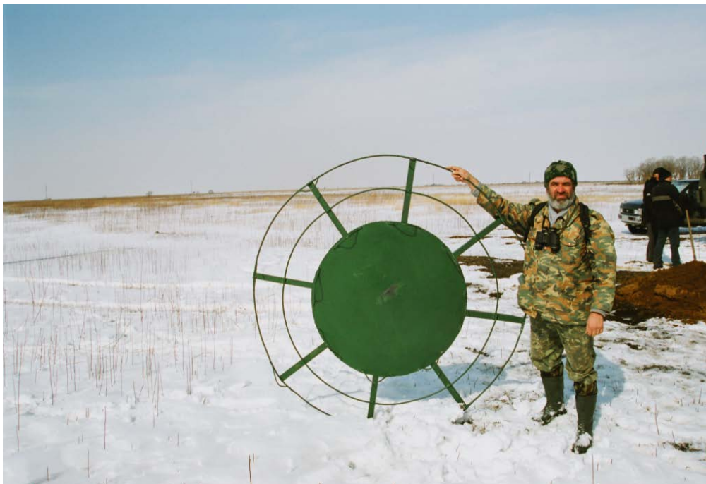
Рис. 8.2.2.2а, б. Приспособления на опоре линии электропередач, препятствующие использованию дальневосточным аистом ( Ciconia boyciana ) в качестве присады. Фото Д.В. Коробова.
